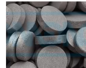
Рисунок 30. Геттеры из электролитического титанового порошка
