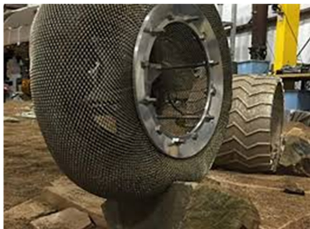
Рисунок 73. Изготовление из никелида титана каркаса шин с «памятью формы» для большегрузных автомобилей
