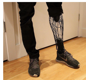
Рисунок 40. Фрагмент эндопротеза коленного сустава и полный каркасный протез голени, выполненные из титана методом EBM.
