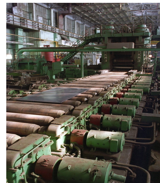
Рисунок 55. Производство холоднокатаного титанового листа с применением рулонного и штучного способов.
