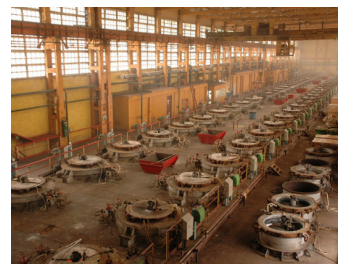
Рисунок 27. Промышленная линия металлотермического восстановления \text{Ti} из \text{TiCl}_4
