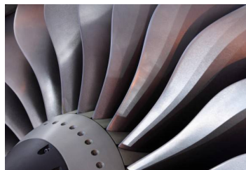
Рисунок 34. Лопатки турбины, изготовленные из титанового порошка по технологии «ГИП + деформация»
