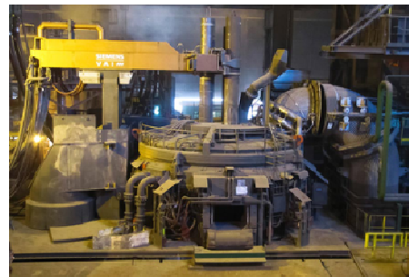
Рисунок 2. Электродуговая печь для выплавки ферросплавов из рудного концентрата.
