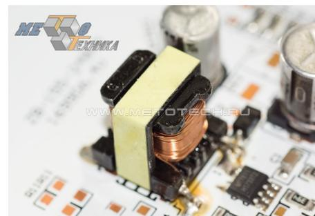
Рисунок 7. Импульсный трансформатор.
