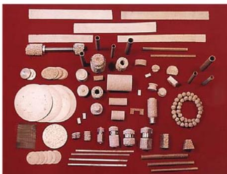
**Рисунок 9. Образцы пористых материалов и имплантатов из никелида титана для вертебрологии (в виде эндопротезов, изделий пластинчатой и цилиндрической конфигурации).**
