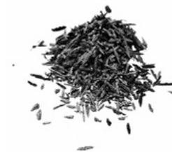
Рисунок 7. Порошок ванадия электролитический
