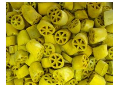
Рисунок 19. Сульфо-ванадато-диатомовый катализатор окисления сернистого ангидрида в производстве  $H_2SO_4$
