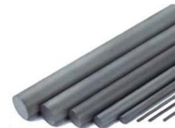
Прутки,  $\varnothing$  которых превышает 60 мм, в обиходе именуют кругами, хотя в тексте ГОСТ 25501-82 «Заготовки и полуфабрикаты из цветных металлов и сплавов. Термины и определения» понятие «круг» отсутствует.
